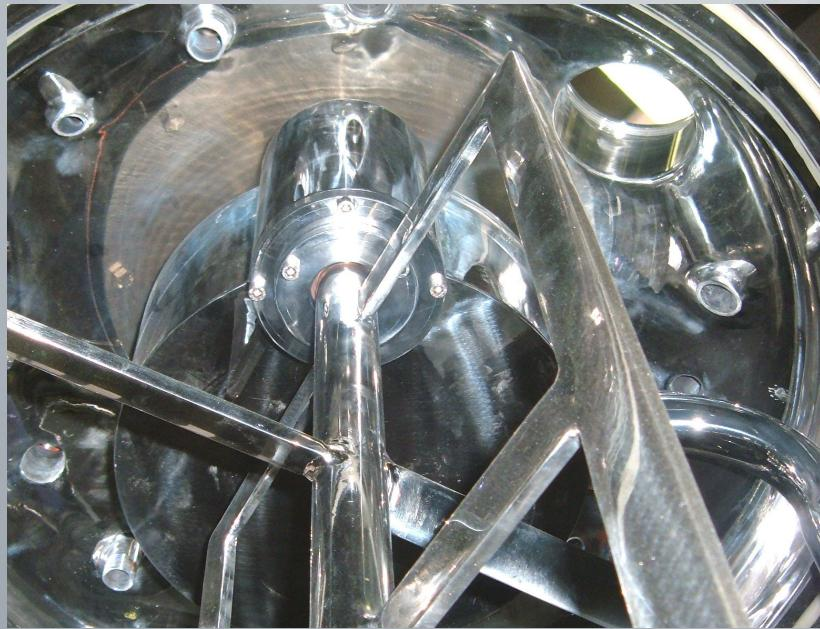
Particolare del planetario di un turboemulsore dalla capacità utile di 150 litri
